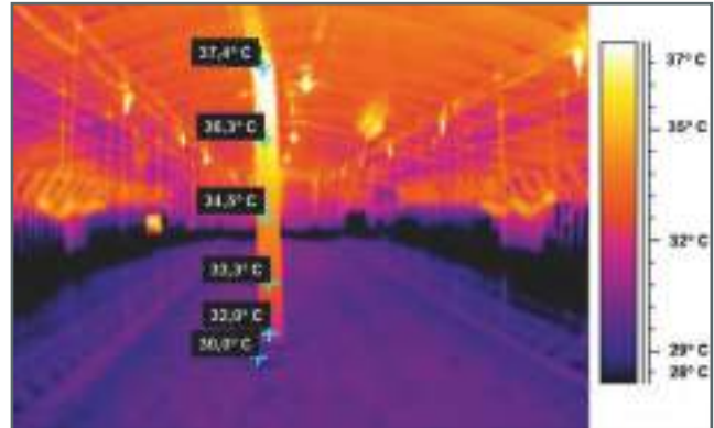
Temperatura siempre tiene una gradiente vertical lo que es un aspecto crítico en sistemas de jaulas. Cortesía de M. Czarick – UGA
