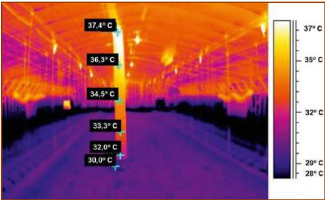
Температура всегда изменяется в зависимости от высоты. Будьте особо осторожны при замерах в клеточных системах
