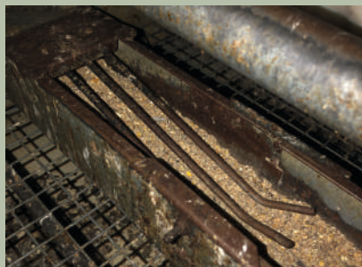
Système de protection des poussins en poussinière volière pour éviter que le poussin ne se déplace dans la chaîne.
