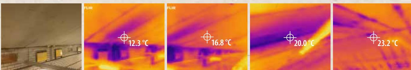
Um bom sistema de ventilação transversal direciona o ar entrante em direção ao telhado, onde a temperatura é mais elevada, aquecendo-o. A sequência seguinte de imagens térmicas mostra-nos o efeito da ventilação transversal ótima.
