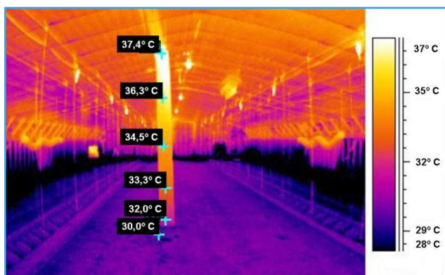
Die Temperatur hat immer einen Höhengradienten. Bei Käfigsystemen sollte dies sorgfältig überlegt werden.
